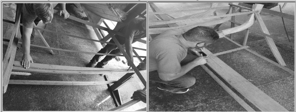
Figura 3 - Tirando as medidas para determinar a posição das cavernas
