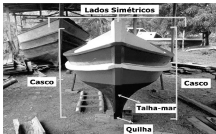
Figura 2 - Simetria existente na embarcação
